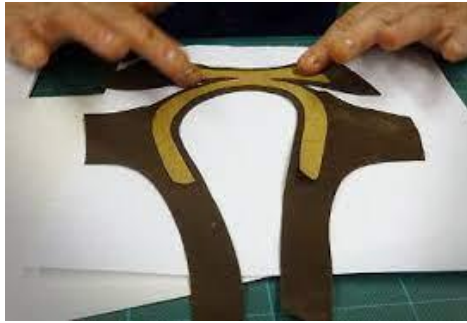
Şekil 49. Ayakkabı parçalarının yapıştırılması. Kaynak: CTCP
