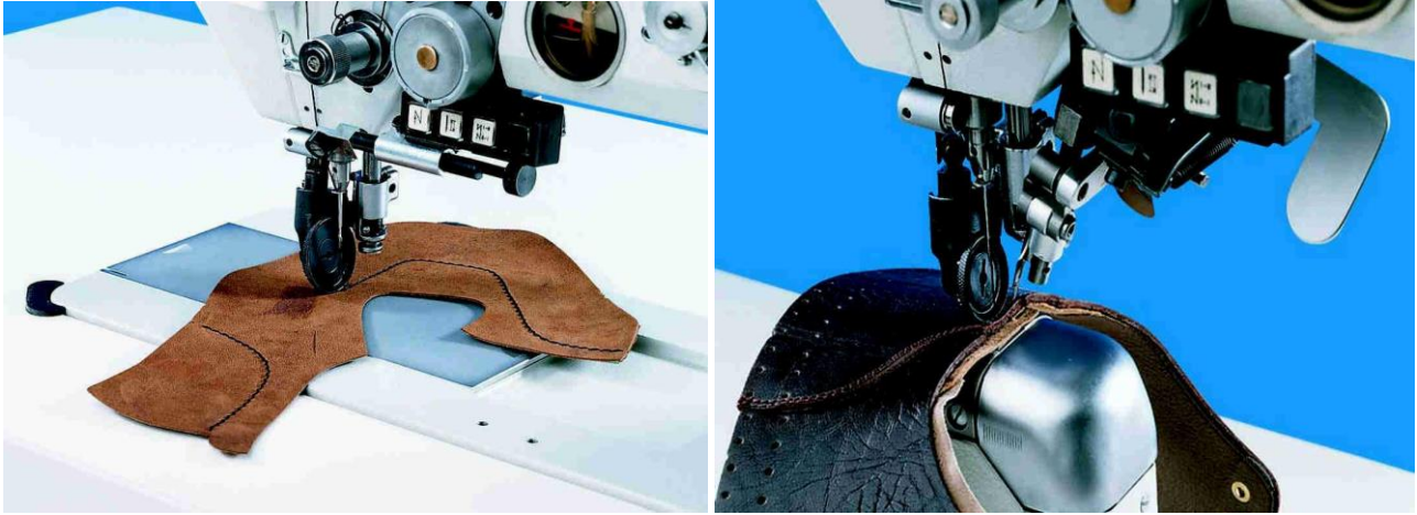
Şekil 7. Farklı tipte dikiş makineleri. Solda düz dikiş makinesi. Sağda sütun dikiş makinesi
