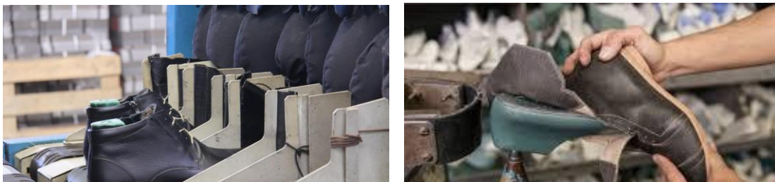
Şekil 14. Solda: Ayakkabıları stabilize etmek için makine (düşük sıcaklık); sağda kalıp çıkarma makinesi
