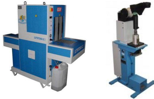
Şekil 14. Solda: Ayakkabıları stabilize etmek için makine (düşük sıcaklık); sağda kalıp çıkarma makinesi
