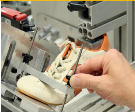
Şekil 50. Ayakkabı dayanıklılık testi. Kaynak: https://pfi.hk/resources/an-overview-of-various-test-methods-of-flexing-durability-for-footwear/
