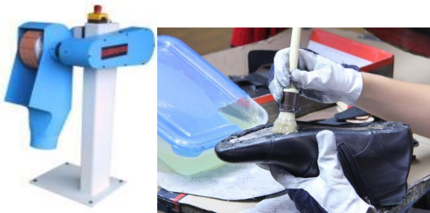
Şekil 12. Kaba işleme ve yapıştırma
