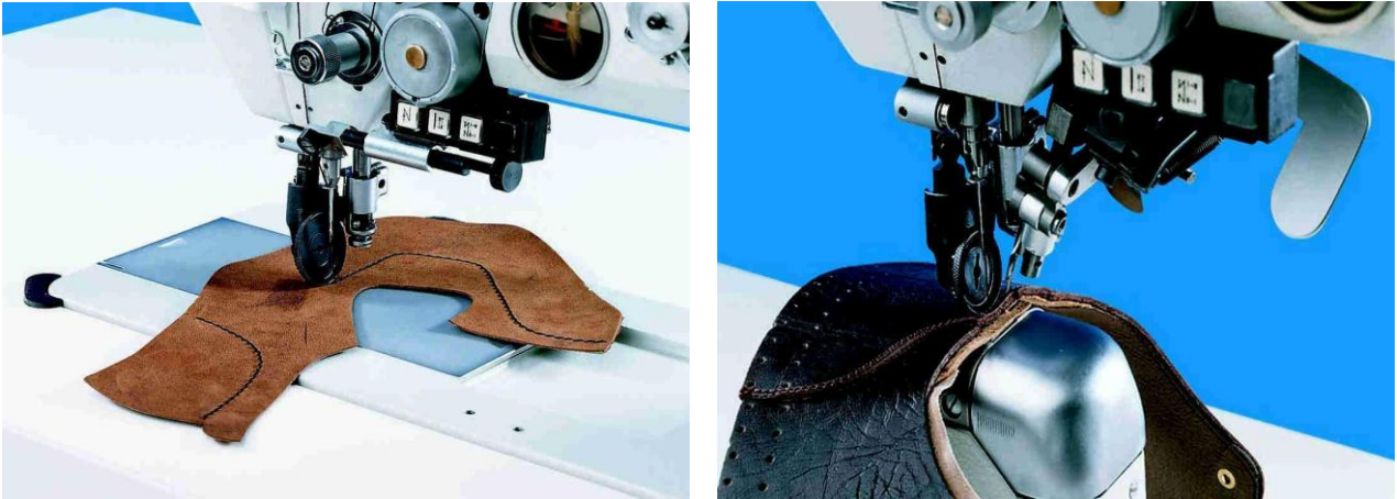
Σχήμα 7. Διαφορετικοί τύποι ραπτομηχανών. Αριστερά η επίπεδη ραπτομηχανή. Δεξιά η ραπτομηχανή στήλης
